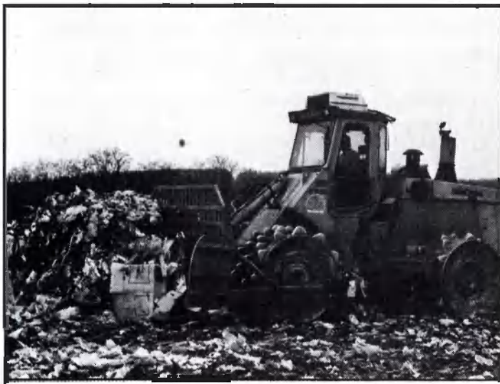
Munkában a kompaktor. Tolólapjával elegyengeti a hulladékot, míg a büttykös hengerek tömörítik azt.
